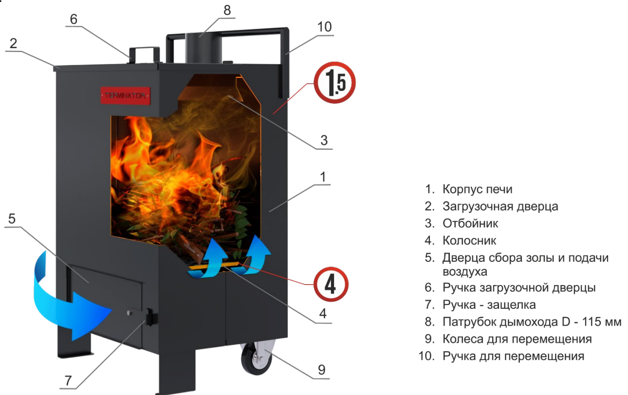
Рис. 1 Устройство печи для сжигания мусора TERMINATOR .
